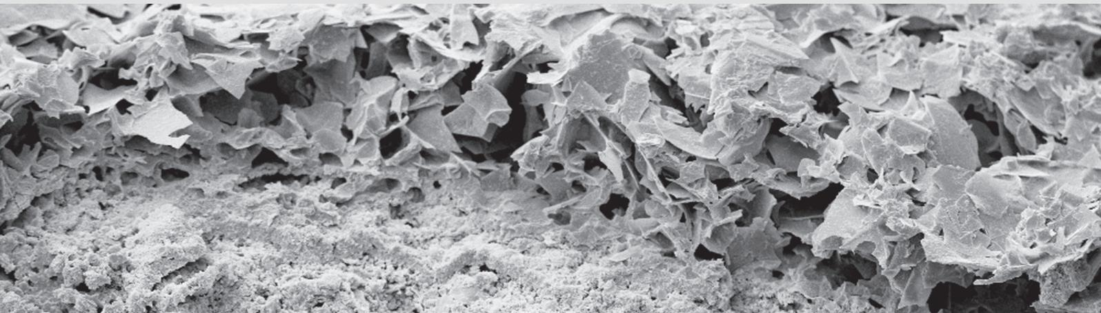
Je mehr Material (Mikroporen) auf der Fläche ist, umso mehr Kondensat kann sie tropffrei aufnehmen.
